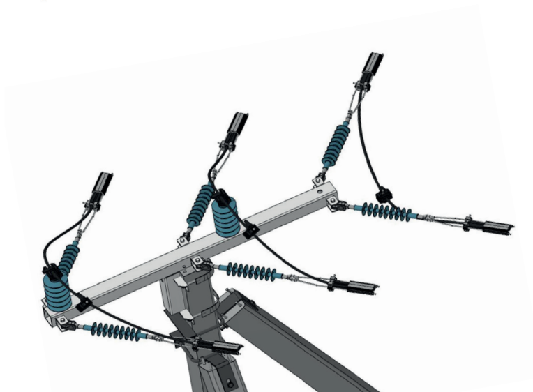
Угловая анкерная железобетонная опора
